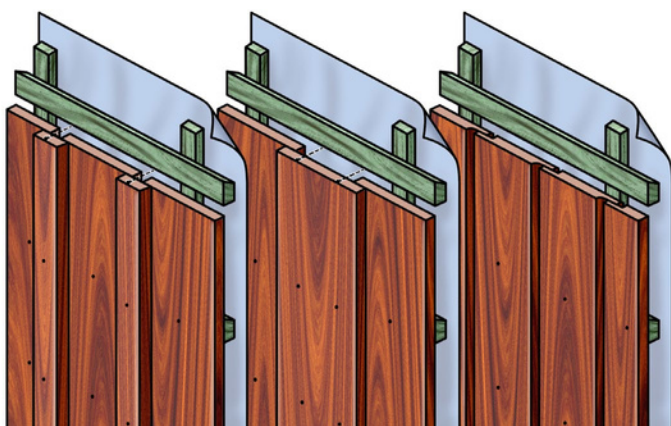
Tekening 3 Verticale gevelbekleding: v.l.n.r. opdekwerk, opdekwerk en rabat met halfhoutse overlap (Channel siding).
