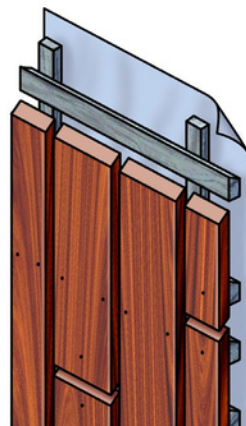
Tekening 4 Verticale open gevelbekleding op dubbel regelwerk.
