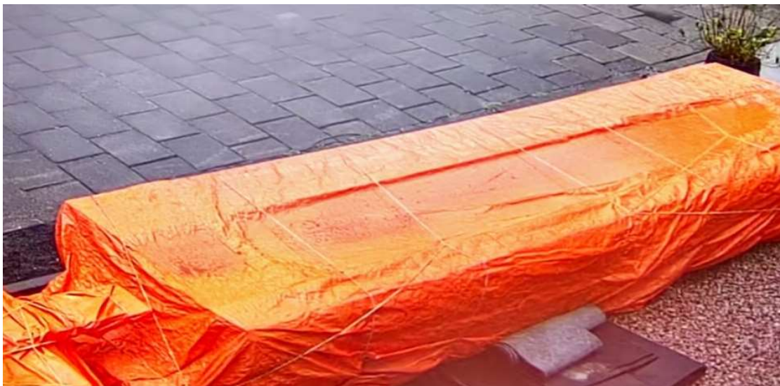
Een voorbeeld van een verkeerde manier van houtopslag. Het zeil zorgt voor een gebrek aan ventilatie.
